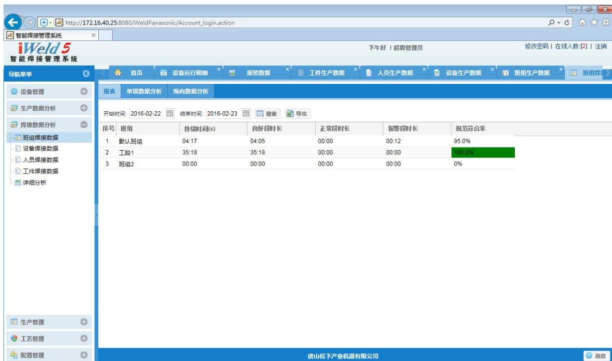
班组焊接数据页面包括【报表】，【单项数据分析】，【纵向数据分析】三个标签。默认打开报表标签项，报表包含每个班组在查询时间段的焊接时间、良好段时长、正常段时长、报警段时长、规范符合率，支持导出为 Excel 格式的文件。
