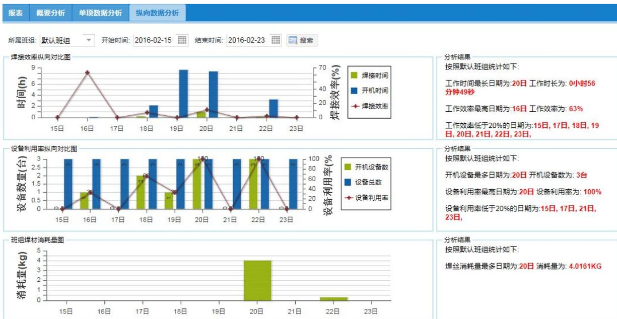
纵向数据分析可以查询某个班组或全部班组一段时间内的数据对比，页面左侧分别显示统计时段内每天的工作时间对比图，加工设备数量对比图，焊丝消耗量对比图，工件焊接数量对比图，页面右侧显示针对左侧图给出的分析结果，显示每种对比数据极值出现的日期，便于管理者对一段时
