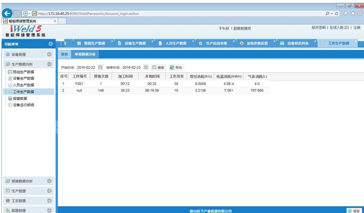
工件生产数据页面包括【报表】，【单项数据分析】两个标签。默认打开报表标签项，报表包含每个人员在查询时间段的工件编号、焊接次数、加工时间，开机时间，工作效率，焊丝消耗，电能消耗，气体消耗，报表数据支持导出为 Excel 格式的文件。
