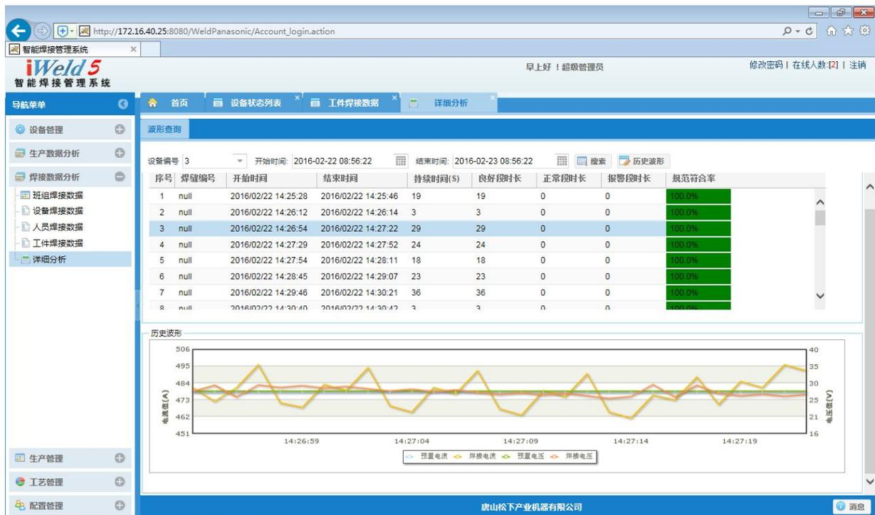
本页面可以查询某一焊接设备在查询时间段内的详细焊接波形数据，输入【设备编号】与【开始时间】【结束时间】，点击【搜索】，列表显示在本时段的所有焊缝数据，包括焊缝的作业时间、焊缝时长、规范符合率。选中某一条焊缝数据，点击【历史波形】，下方的绘图窗口将选中焊缝的每秒的电流电压波形曲线绘制出来。
