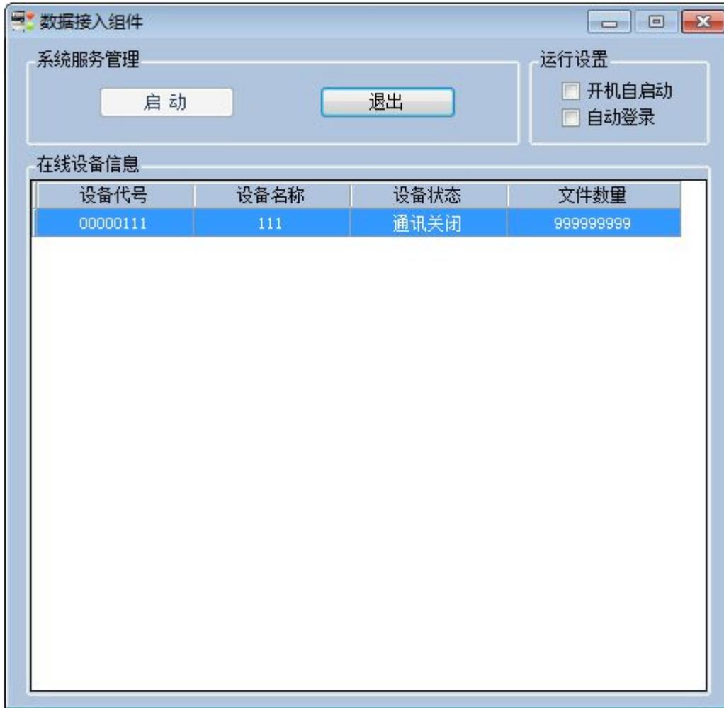
如果此时焊接设备与 iWeld 服务器具备正常通信的条件，焊接设备开机后，数据接入组件与焊接设备自动进行数据通信。
