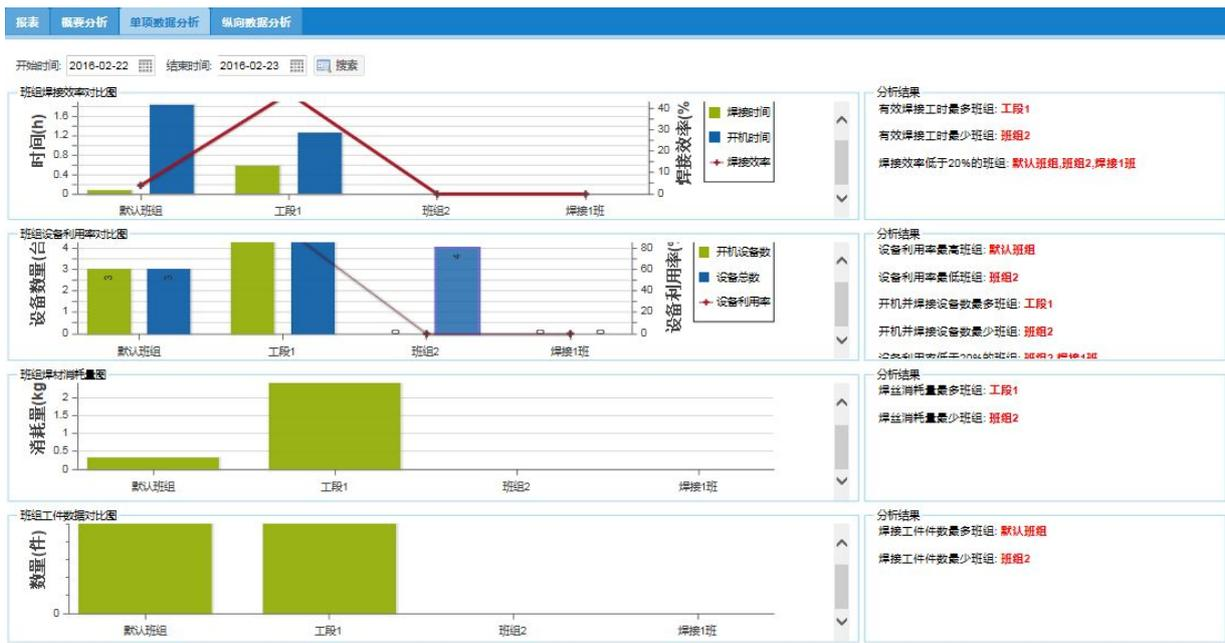
单项数据分析页面采用柱形图与分析结果的形式，页面左侧分别显示不同班组的工作时间对比图，加工设备数量对比图，焊丝消耗量对比图，工件焊接数量对比图，页面右侧显示针对左侧图给出的分析结果，将每种对比数据的最高值与最低值进行显示，将某一分析数据超出设定的极值的班组进行显示，便于管理者及时发现生产中存在的问题。
