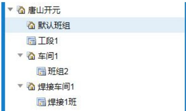
此时焊接 1 班被设置为焊接班组，在【设备监控页面】，【设备配置】页面的班组选项便可以看到“焊接 1 班”，查询数据报表时，该班组便可以体现到数据报表中。
