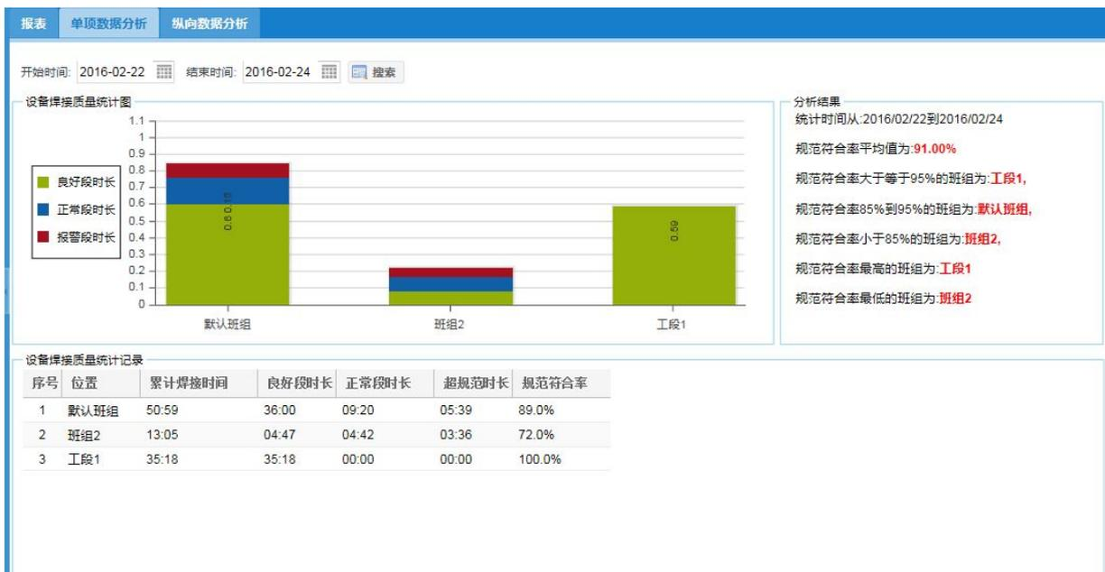
本页面设备焊接质量统计图，显示每个班组的电流分布情况，良好段时长、正常段时长、报警段时长根据【配置管理】【系统参数设置】页面中设置的规则进行计算，规范符合率是指电流良好段与正常段占所有焊接时间的比例，右侧分析结果显示规范符合率的平均值，以及哪些班组较高或较低，便于工艺部门或检验部分及时了解焊接设备的规范符合情况。
